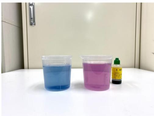
安全に透析が行えるよう透析開始前に、RO水の硬度、残留塩素等の確認を行います。
